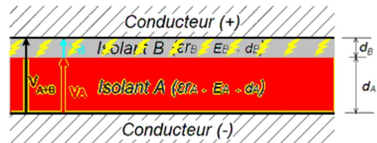
V : Tension d : epaisseur isolant E : rigidité dielectrique εr : permittivité relative
